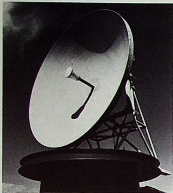
Bild 6. 6-GHz-Cassegrain-Antenne (Werkfoto SEL)
